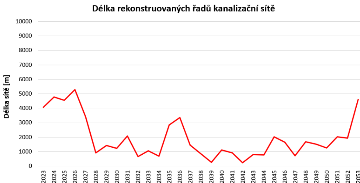
Obr. 7-2 Tempo obnovy kanalizační sítě
